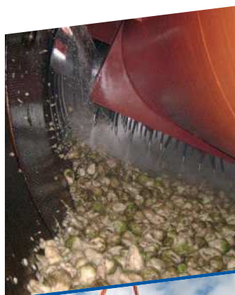
Intérieur du laveur finisseur : lavage des betteraves
